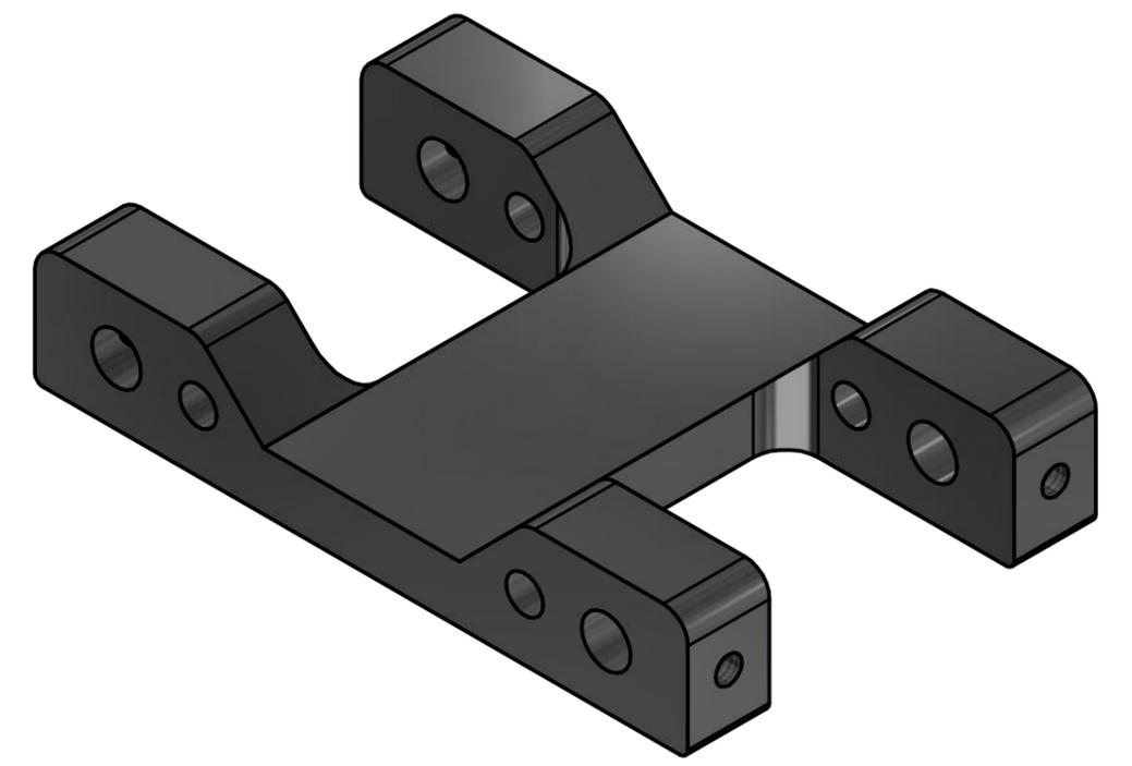
Угловой усилитель предназначен для монтажа каркасной системы 60 мм. Имеются отверстия  $\Phi 6$  мм под монтажные стержни RSS-6. Для фиксации стержней предусмотрены резьбовые отверстия M4. Является дополнительным направляющим элементом базового усилителя 60-BSPA, а также может быть независимым скользящим элементом, задающим точность направления стержням.
